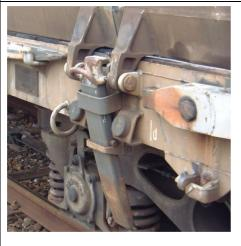
Après le chargement ou le déchargement, redresser les haussettes latérales, relever et accrocher les supports, remettre les ranchers pivotants en position verticale et mettre les verrouillages en place.
