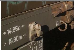
Boucles d'attache fixes (droite). Crochets à cliquet (gauche).
