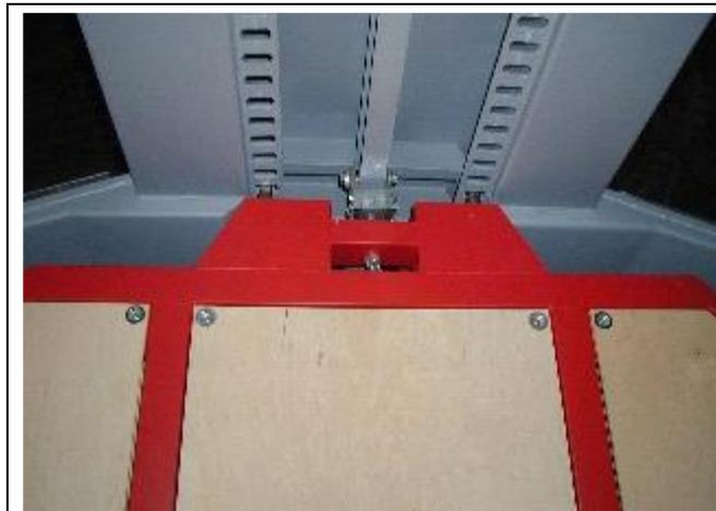
Suspension de la paroi de séparation au niveau du toit
