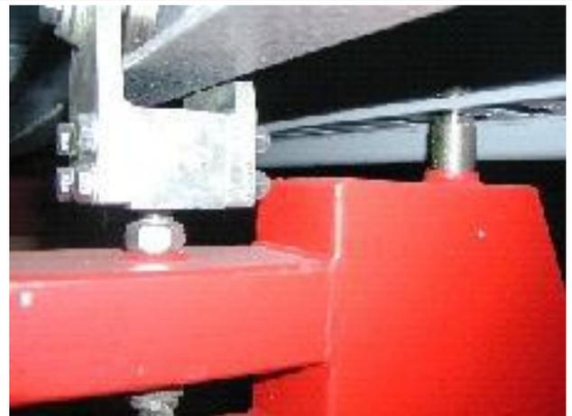
Galet tendeur et pivot de verrouillage
