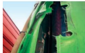
Bâche déchirée et œillets défectueux
