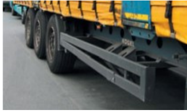
Protection anti-encastrément latérale déformée
