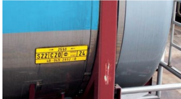
Conteneurs-citernes avec codification UIC
