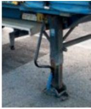
Manivelle de béquille désolidarisée
