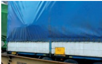
Chargement en appui contre la bâche
