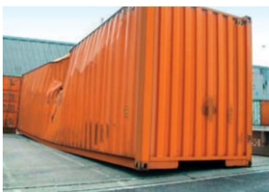
Conteneur fortement endommagé
