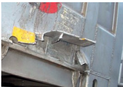
Rainure de prise endommagée
