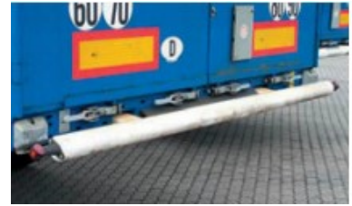
Protection anti-encastrément arrière relevée
