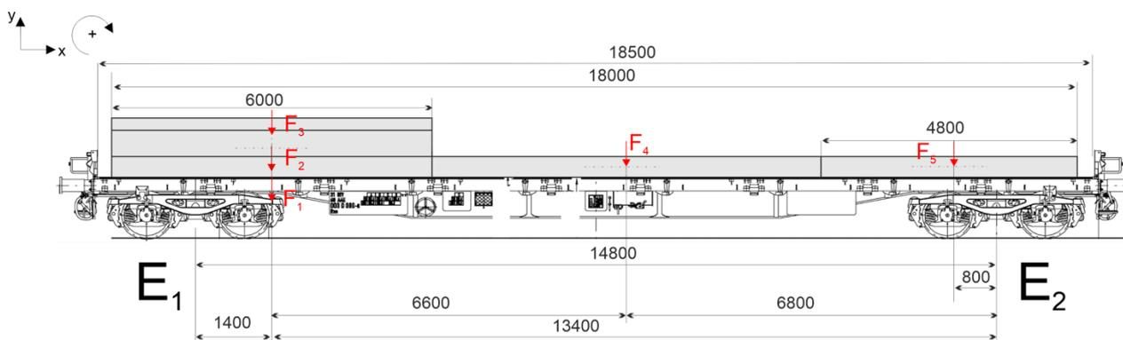
Berechnung der Einzellasten anhand der Volume und der Dichte für Aluminium 2700 kg/m<sup>3</sup>
