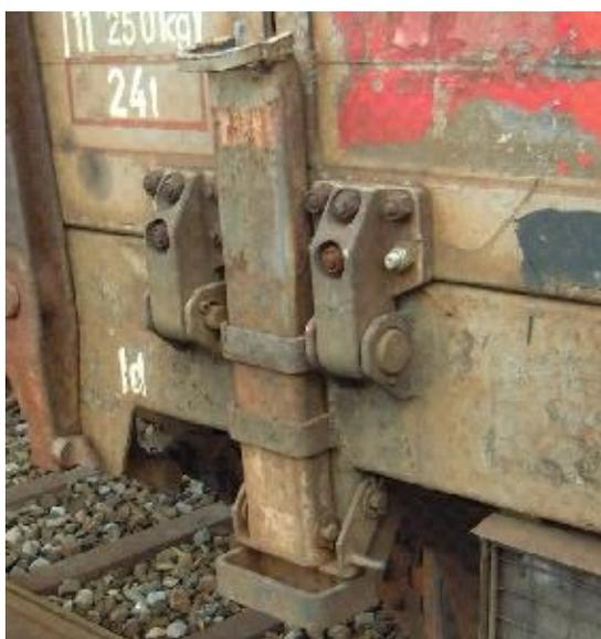
Seitenbordhalter bei heraus geklappter Sicherung um einige cm abgesenkt.
