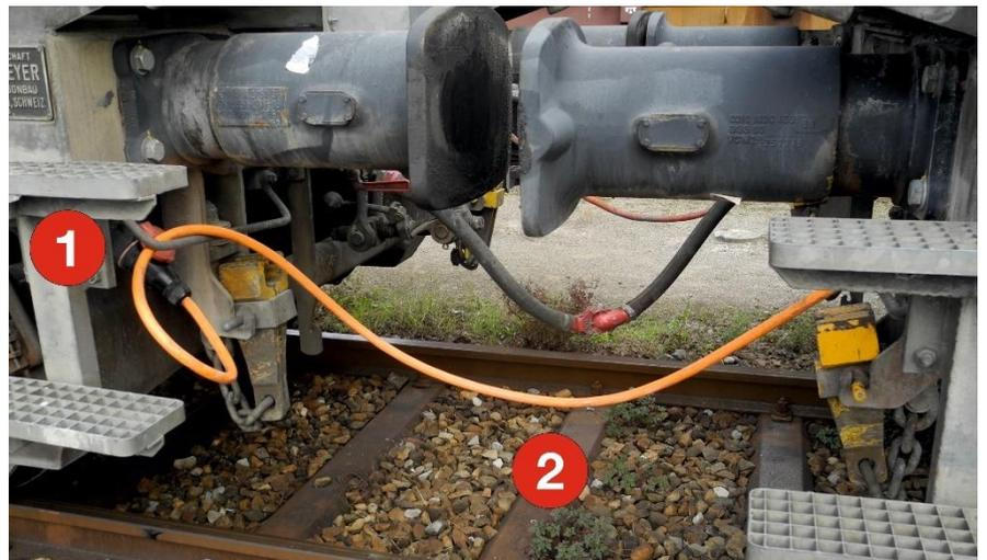
Vor dem Einstecken des Steckers in die Steckdose (1) des nächsten Wagens ist mit dem Kabel eine Schlaufe um den Kupplergriff zu ziehen.
