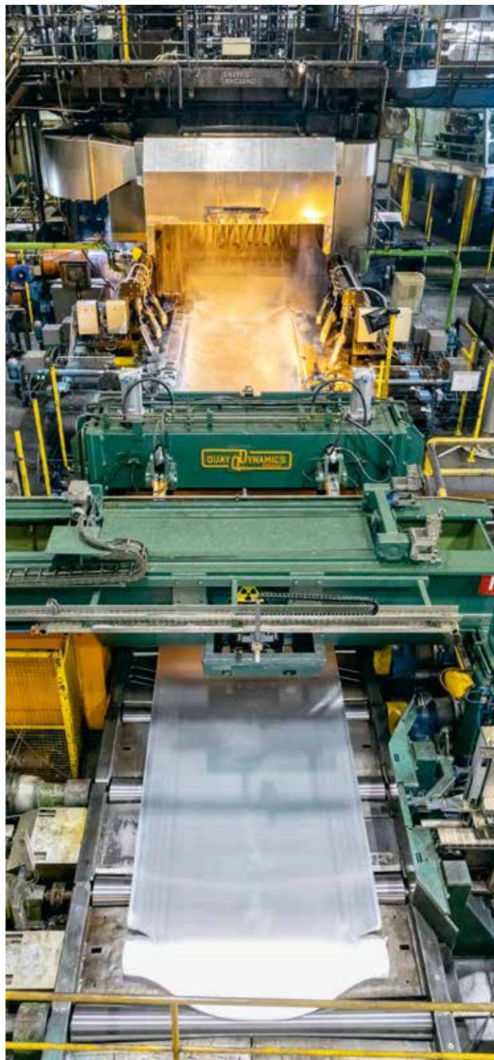
La linea di laminazione di Novelis: attraverso ripetuti passaggi si forma un sottile nastro di lamiera dalle spesse barre di alluminio.
