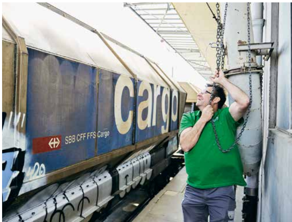
Dal silo alla rotaia: un carro ferroviario contiene circa 60 tonnellate di cereali, più del doppio rispetto a un camion.
