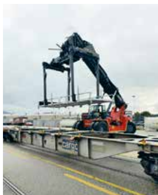
In alto a sinistra: la nuova sovrastruttura viene caricata sul telaio nel terminale di Oensingen.
