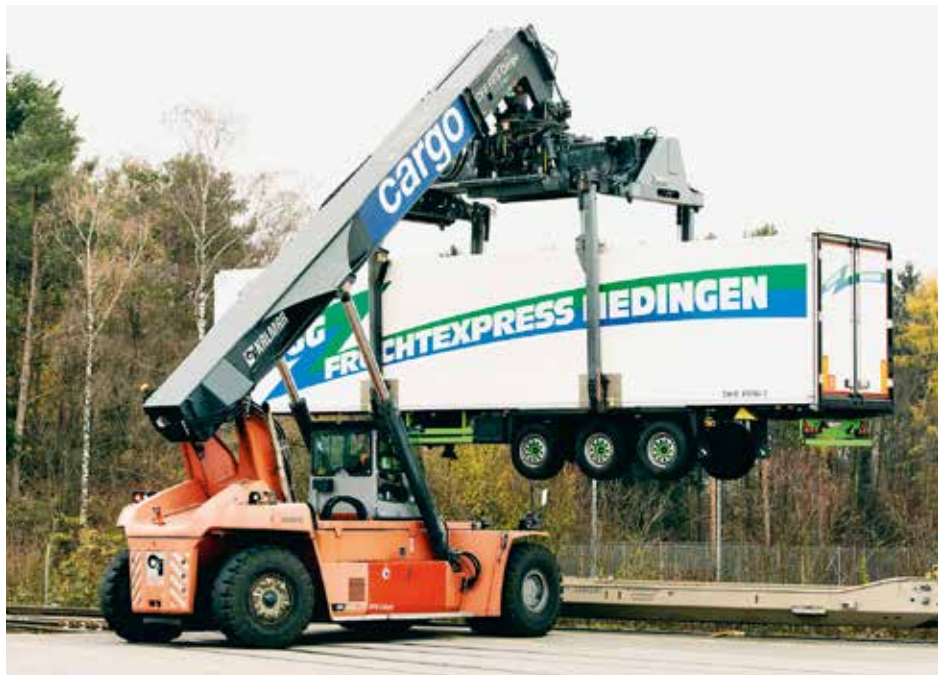
Solo il reachstacker permette di sollevare container e semirimorchi (in foto) sia da sopra, sia da sotto.
