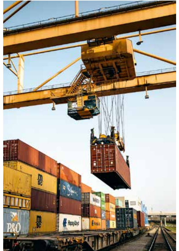
Container «volanti»: trasbordo dal battello alla ferrovia nel terminale Contargo a Basilea.
