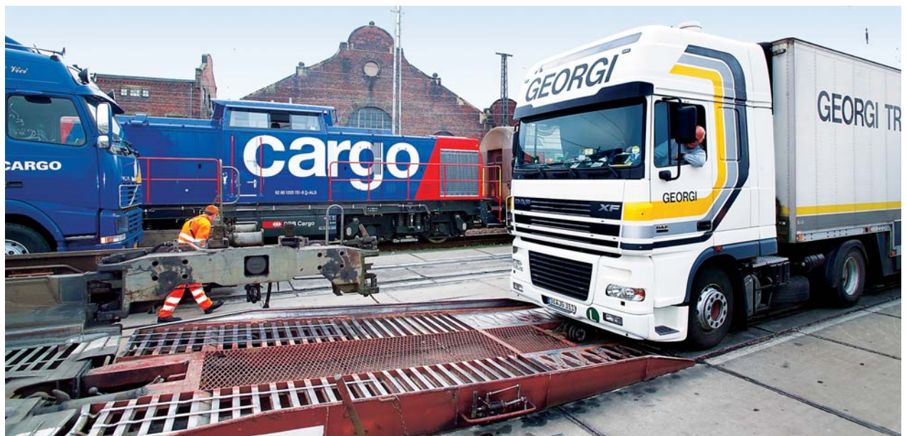
Attraverso la rampa la merce aerotrasportata arriva alla «autostrada viaggiante».
