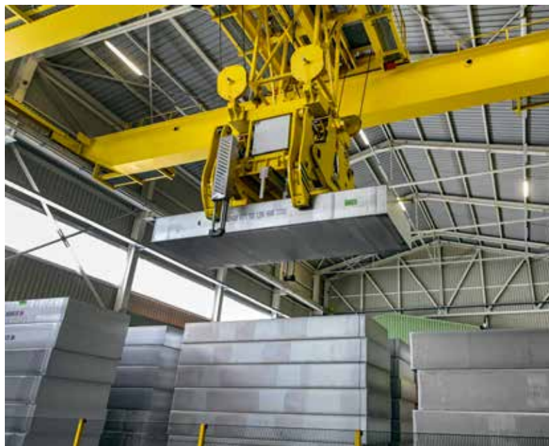
C'est à partir de barres d'aluminium de ce type, transportées en train dans l'usine Novelis de Sierre, que sont obtenues de minces bandes d'aluminium par laminage.
