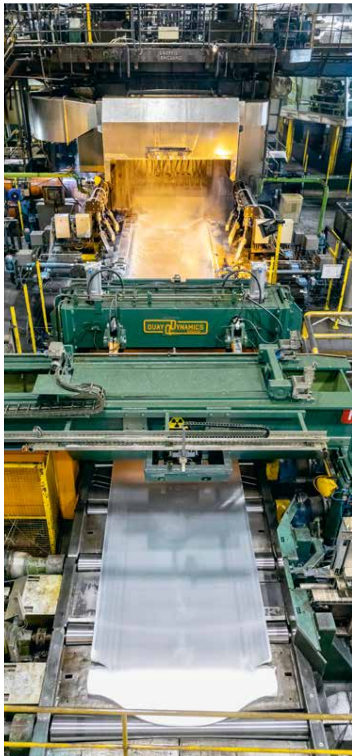
La ligne de laminage Novelis: les va-et-vient répétés transforment l'épaisse barre d'aluminium en une fine bande de tôle.
