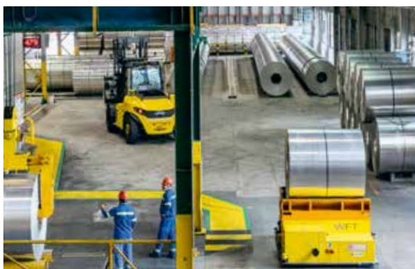
Des véhicules autonomes transportent les bobines dans l'entrepôt.
