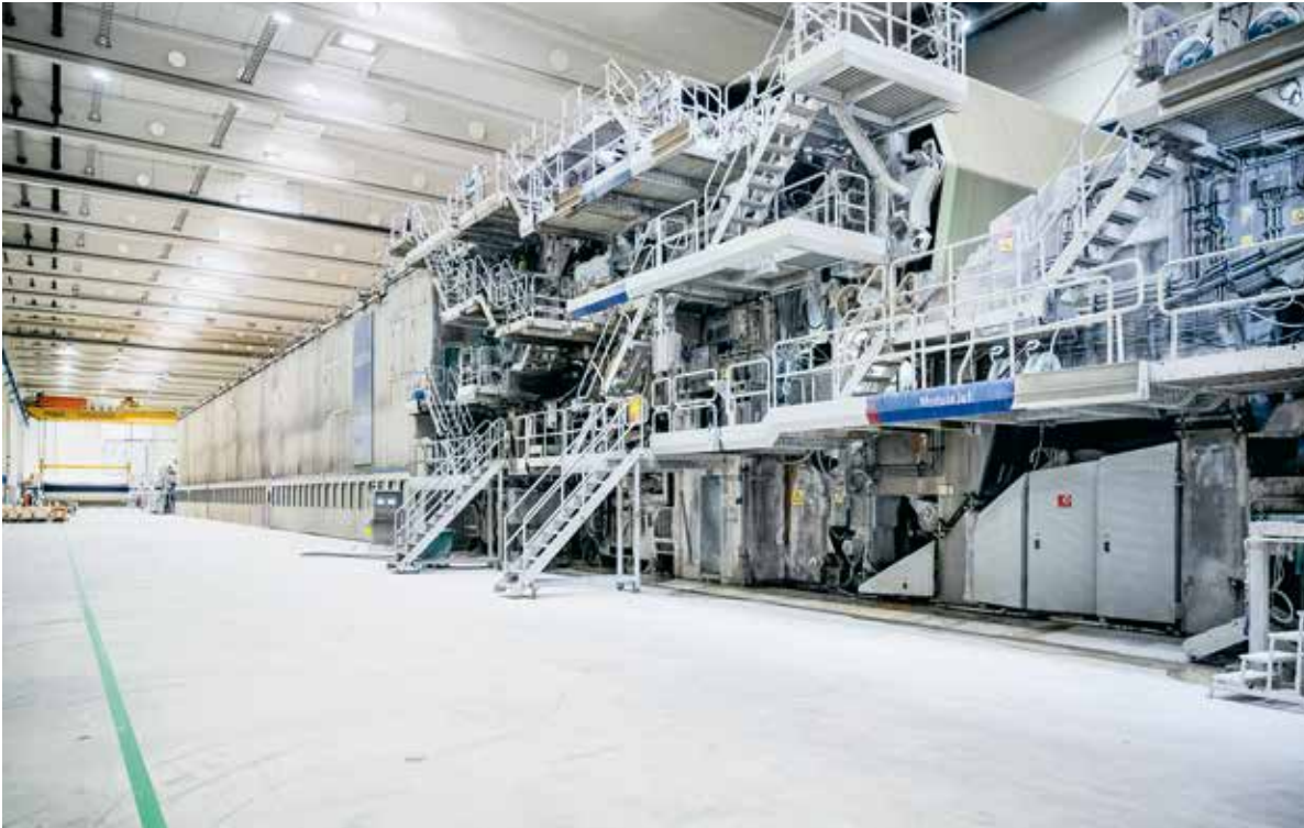
La machine à papier de Perlen mesure 200 mètres de long et 10 mètres de haut. Elle fabrique du papier journal sur le dernier site de production de ce type en Suisse.
