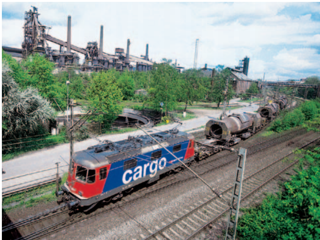
Une locomotive suisse chargée de fer liquide allemand, quelque part entre Dillingen et Völklingen.
