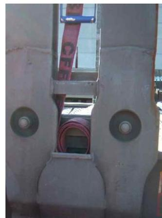
Faire un nœud avec l'extrémité de la sangle (assurer) ou l'enrouler et la remettre en place.
