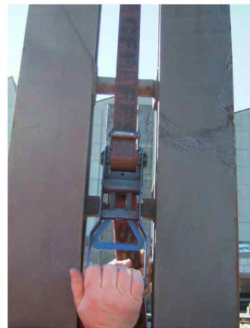
Poser les sangles bien à plat sur le chargement (dans la mesure du possible) en veillant à ne pas les tordre. Introduire l'extrémité de la sangle dans le rochet et la tendre; encliqueter le tendeur du rochet.
