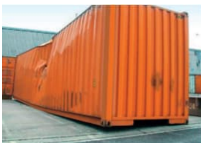
Conteneur fortement endommagé
