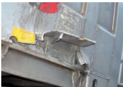
Rainure de prise endommagée
