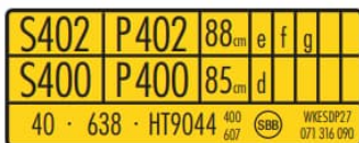
Plaque de codification pour semi-remorques (admise pour plusieurs hauteurs de sellette)
