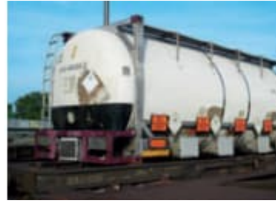
Conteneur-citerne à quatre compartiments avec marquage correct des marchandises dangereuses
