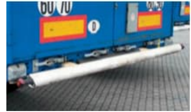
Protection anti-encastrement arrière relevée
