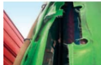
Bâche déchirée et œillets défectueux
