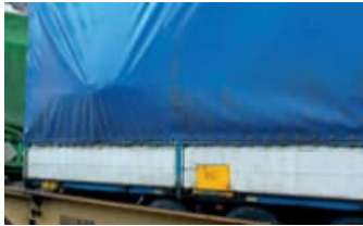
Chargement en appui contre la bâche
