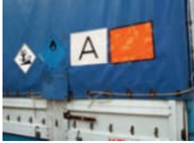
Semi-remorque avec marquage correct, spécifique aux déchets et aux marchandises dangereuses (transport maritime)
