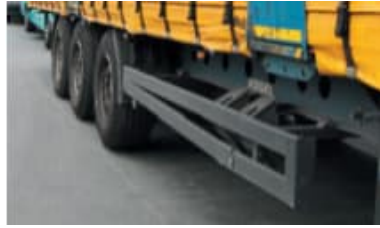
Protection anti-encastrement latérale déformée
