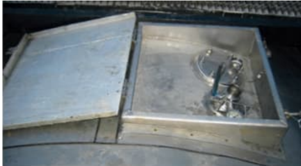
Couvercle de protection des vannes non fermé
