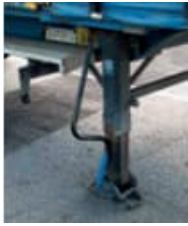
Manivelle de béquille désolidarisée
