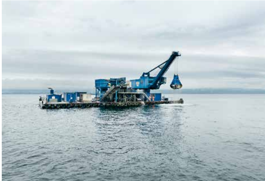
Auf dieser mobilen Plattform baut Sables et Gravieres La Poissine Kies und Sand aus dem Neuenburgersee ab, pro Jahr sind es rund 340 000 Tonnen – bislang war noch kein Goldstück dabei.
