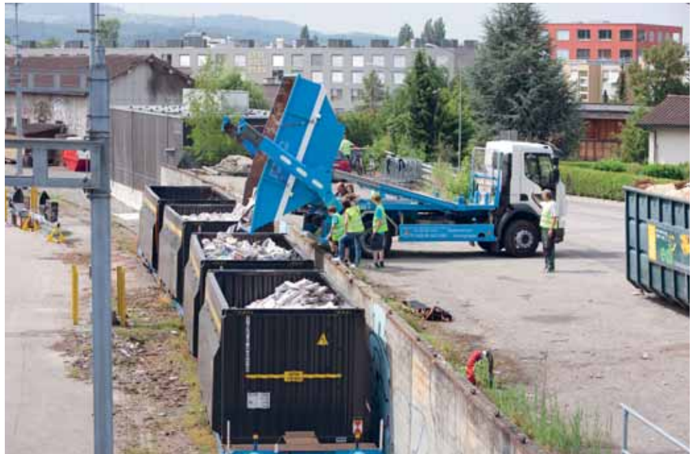
Das Altpapier wird in modernen Innofreight-Behältern transportiert, welche eine optimale Auslastung der Wagen erlauben.
