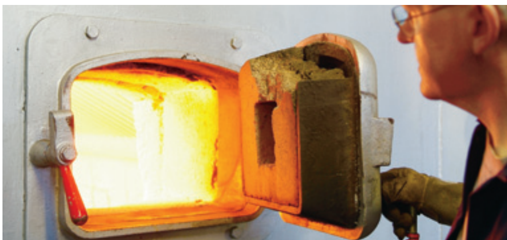
Die Kohle verbrennt bei 1100 Grad Celsius, es entsteht Strom und Wärme.
