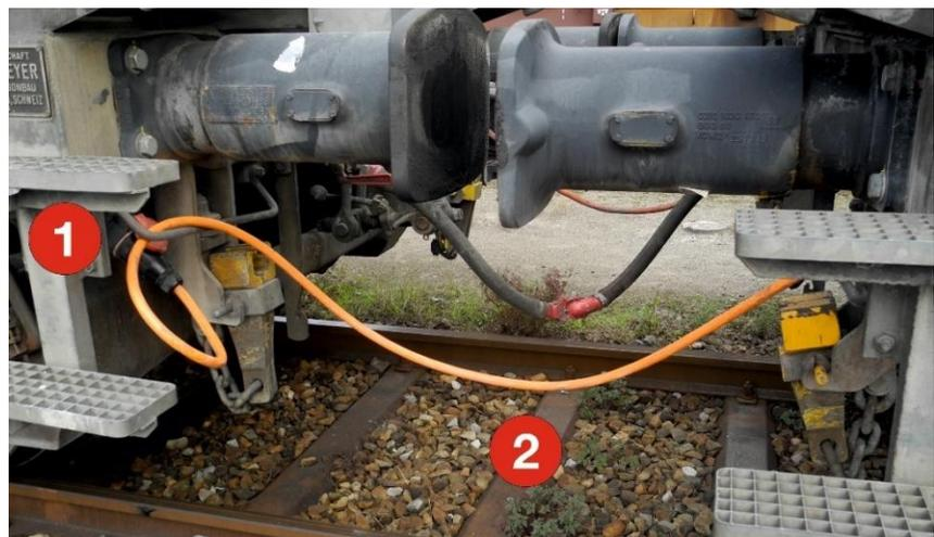
Avant d'introduire la fiche dans la prise (1) du prochain wagon, enrouler le câble de façon à former une boucle autour de la poignée de l'attaleur.
